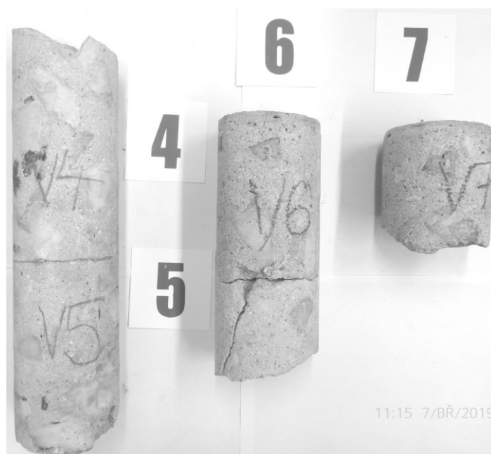
Foto č.3.2: Dokumentace vývrtů V4 - V7 pro destruktivní zkoušky pevnosti v tlaku betonu spodní stavby
