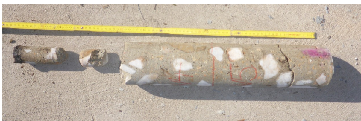
FOTO č.3.3: Dokumentace vývrtu ze sondy SK3 do opěry 1
